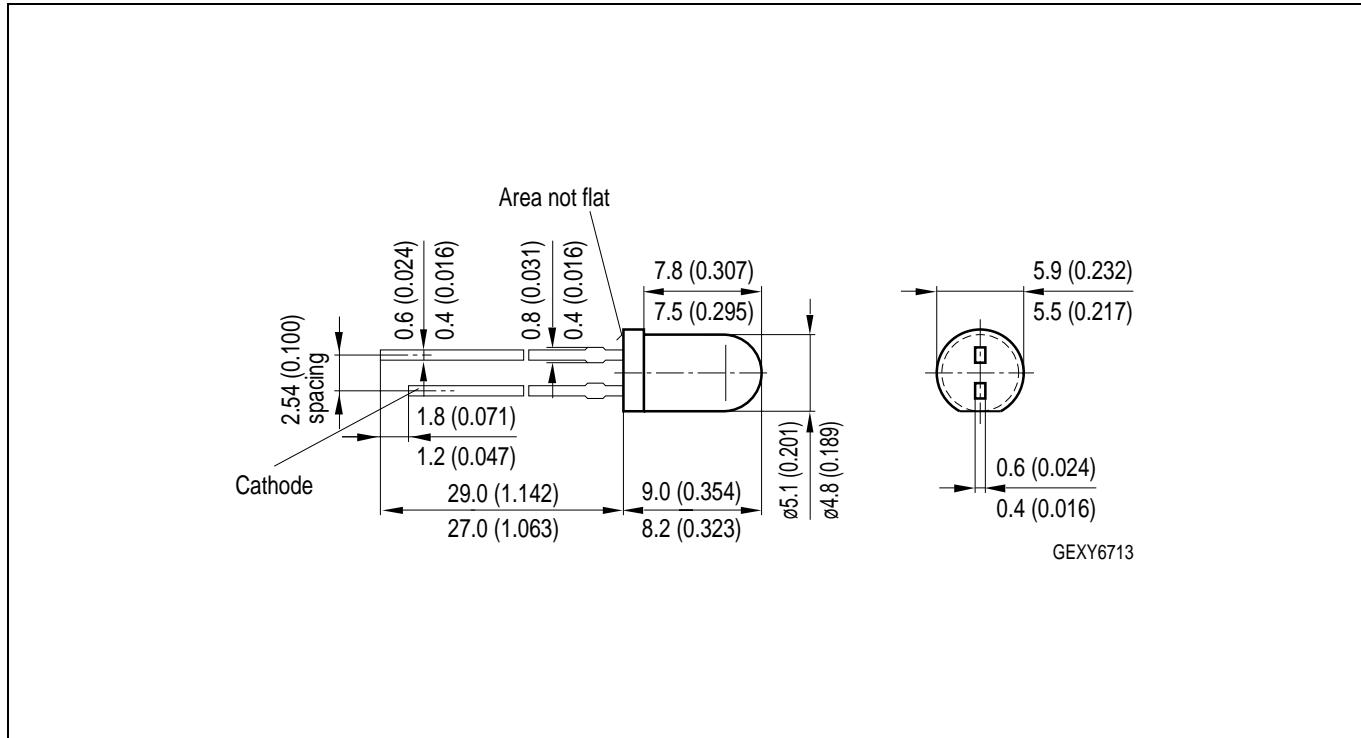
Maße werden wie folgt angegeben: mm (inch) / Dimensions are specified as follows: mm (inch).
