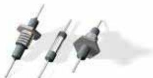
Фильтр керамический проходной неизолированный, для работы в цепях постоянного и переменного тока и в импульсных режимах для подавления высокочастотных помех в диапазоне частот 0,7 - 10000 МГц. Применяется в компьютерах, цифровых подвижных радиосистемах, цифровых телевизионных и других системах, в том числе для соединителей. Всеклиматическое исполнение (В). Изготавливается в соответствии с АДПК.431145.002 ТУ.
