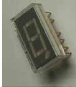
Фосфид-арсенид галлиевые цифровые индикаторы зелёного цвета свечения, в пластмассовом корпусе, состоящие из дискретных элементов, изготовленных по эпитаксиально-диффузионной технологии, предназначенные для визуальной индикации. Максимальная высота знака 7 мм. АЛС338А; ЗЛС338А - с общим катодом, АЛС338Б; ЗЛС - с общим анодом.
