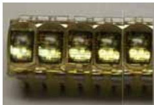
Фосфид-арсенид-галлиевые индикаторы эпитаксиально-планарные цифровые красного свечения цвета пятиразрядные типа КИПВ04А-5/8К, КИПВ04Б-5/8К монолитной конструкции в пластмассовом корпусе, предназначенные для визуальной индикации в аппаратуре. Каждый разряд представляет собой монолитный кристалл. Первый разряд индикаторов КИПВ04А-5/8К состоит из трех сегментов, что позволяет отображать знаки «+», «-». Высота знака 2,5 мм.
