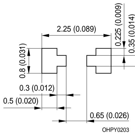
Maße werden wie folgt angegeben: mm (inch) / Dimensions are specified as follows: mm (inch).
