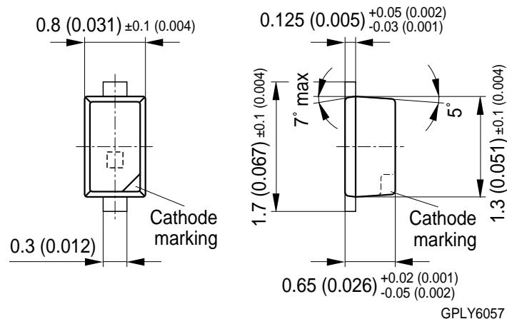
Maße werden wie folgt angegeben: mm (inch) / Dimensions are specified as follows: mm (inch).
