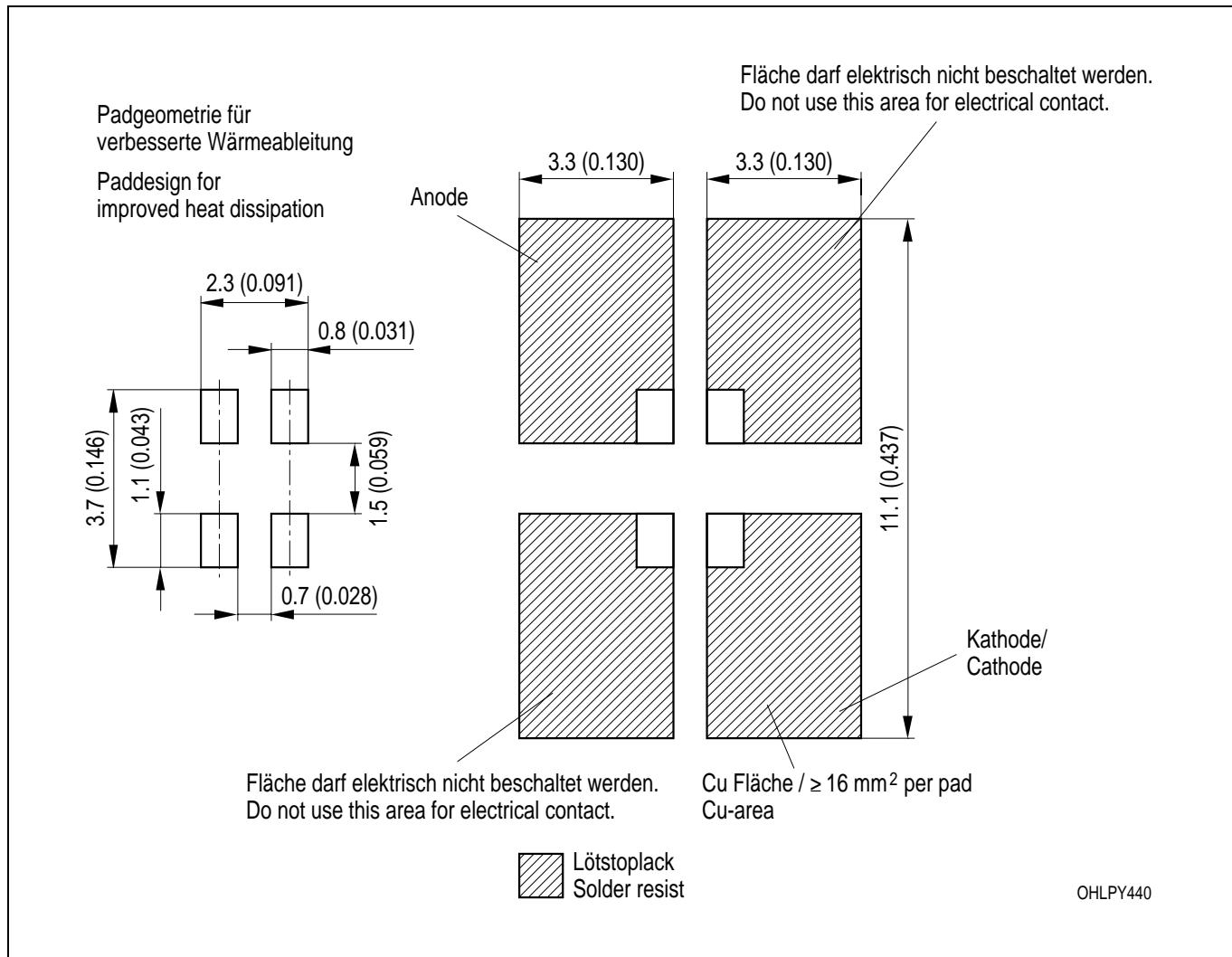
Maße werden wie folgt angegeben: mm (inch) / Dimensions are specified as follows: mm (inch).
