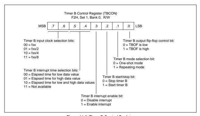
Figure 11-6. Timer B Control Register
