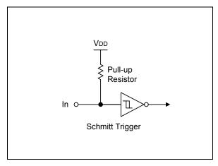
Figure 1-5. Pin Circuit Type B
