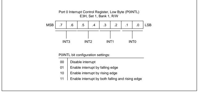
Figure 9-4. Port 0 Low-Byte Interrupt Control Register(P0INTL)
