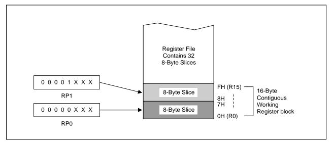
Figure 2-9. Contiguous 16-Byte Working Register Block
