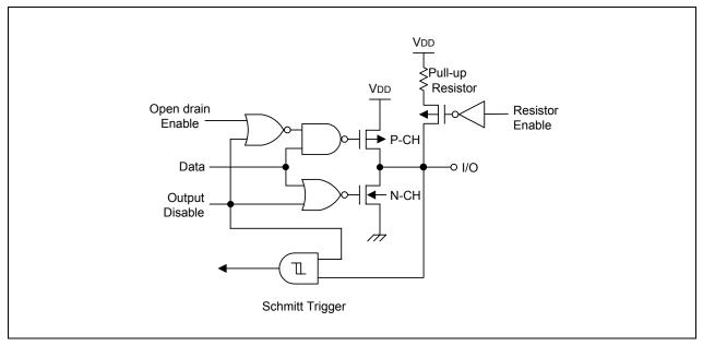
Figure 1-8. Pin Circuit Type E-4 (P0, P1)
