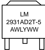
D2PAK D2T SUFFIX CASE 936
