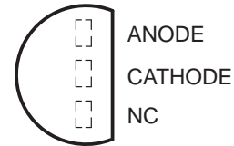
LM285-2.5, LM385-2.5, LM385B-2.5 . . . LP PACKAGE (TOP VIEW)
